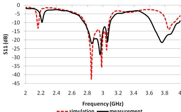
Fig 7.  $S_{11}$  parameter of the antenna
